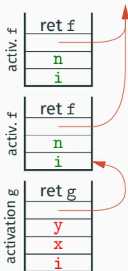
Chaînage des blocs d'activation les plus récents des fonctions englobantes. La tête de la chaîne est passée comme un argument supplémentaire à la fonction appelée.
